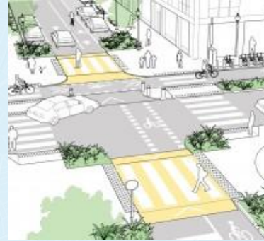
CRUCES PEATONALES QUE FOMENTAN EL CONTROL DE LA VELOCIDAD
