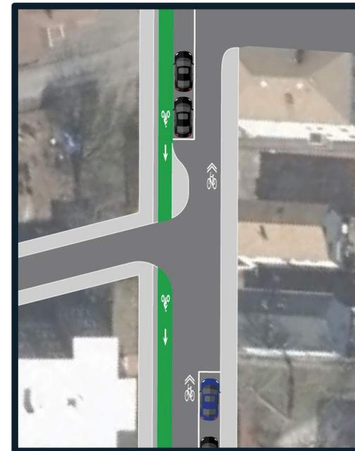
Las chicanas y los cambios de carril son adecuaciones que utilizan distintas medidas como la alternancia en la ubicación del carril de estacionamiento, extensiones de banqueta, o islas con el fin de formar una trayectoria en forma de "S" que reduzca velocidades vehiculares.
