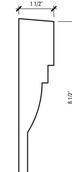
D. BLDG H, WALL BAND TRIM
